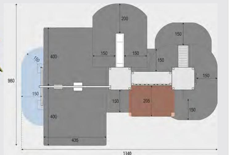
**Hinweise:** <sup>A</sup>Flächenbedarf ist inkl. Sicherheits- und Fallräume und ggf. Platzbedarf für die Ankerfundamente <sup>B</sup>auf Grund der unterschiedlichen Ausläufe der Kunststoffrutsche (233 cm) und der Edelstahlrutsche (247 cm) ändert sich der Flächenbedarf (rot) ggf. beim Austausch einer Rutsche!
