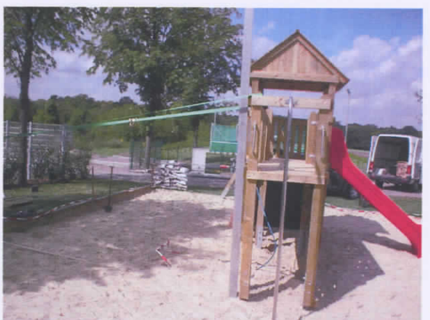
Bild 6: Zugversuch am äußeren Pfosten
