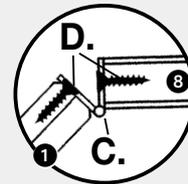
\*ACHTUNG: Schlagleiste 4 mit 2 Schrauben B. von innen an den Blendrahmen 5 schrauben.
