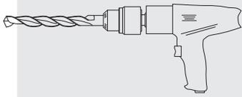
Bohrmaschine mit Steinbohrer  $\varnothing$  8 mm +  $\varnothing$  12 mm
