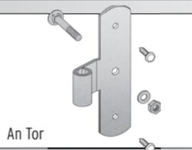
**Zwei Mittelbänder** mit je einer Schlossschraube 8 x 60 mm, Mutter, Unterlegscheibe, zwei Rundkopfschrauben 6 x 30 mm und zwei Abdeckkappen
