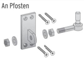
**Zwei Klobenplatten** mit je vier Spanlattenschrauben 5 x 50 mm und **zwei Schraubkloben** mit je zwei Muttern, zwei Polyamid-Scheiben und Abdeckkappe
