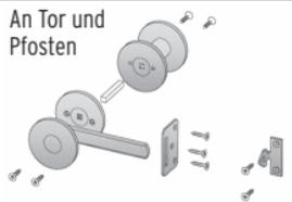
**Schließmechanismus** mit neun Spanlattenschrauben für Rosetten (2 x 2 x), Führungsplatte (3 x), Klinkhaken (2 x) und Vierkantbolzen (Tor mit 12-13 mm durchbohren)
