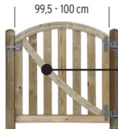
Die Abbildung links zeigt ein Tor DIN rechts angeschlagen. Für einen Anschlag DIN links die **Diagonalleiste** vom Tor abschrauben, spiegeln und neu anschrauben. Leiste ggf. etwas nachschneiden. Es verbleibt mitunter eine schmale Fuge.
