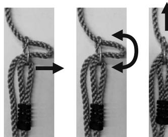
Zur Änderung der Seillänge, das Seil aus der Stellacht lösen und verschieben.
