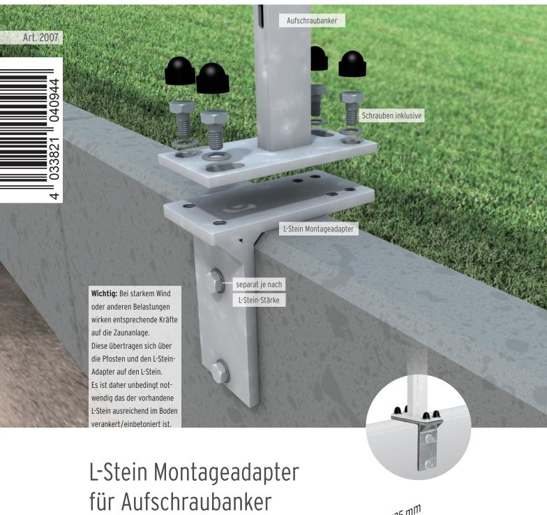
Stahl, feuerverzinkt, Stärke: 10 mm, geeignet für alle TraumGarten-Aufschraubanker. Anker inklusive vier Schrauben 10 x 20 mm (Drehmoment 45 Nm), U-Scheiben und vier Kunststoff-Abdeckkappen.
