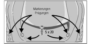
**Hinweis zur Wellenrutsche (Art. 1144, separat erhältlich):** Aus produktionstechnischen Gründen können Markierungen und Prägungen am Rutschenende vorhanden sein. Bitte verwenden Sie zur Verschraubung ausschließlich die beiden vorgebohrten und vorgesenkten Schraubenlöcher. Tipp: Für eine bessere Standsicherheit die Rutsche am Auslauf mit etwas Erdreich anfüllen.
