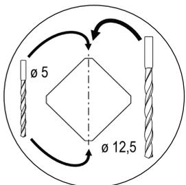
Zur Befestigung der Schaukelhaken erst von beiden Seiten mit  $\varnothing 5$  mm vorbohren, dann mit  $\varnothing 12,5$  mm durchbohren.
