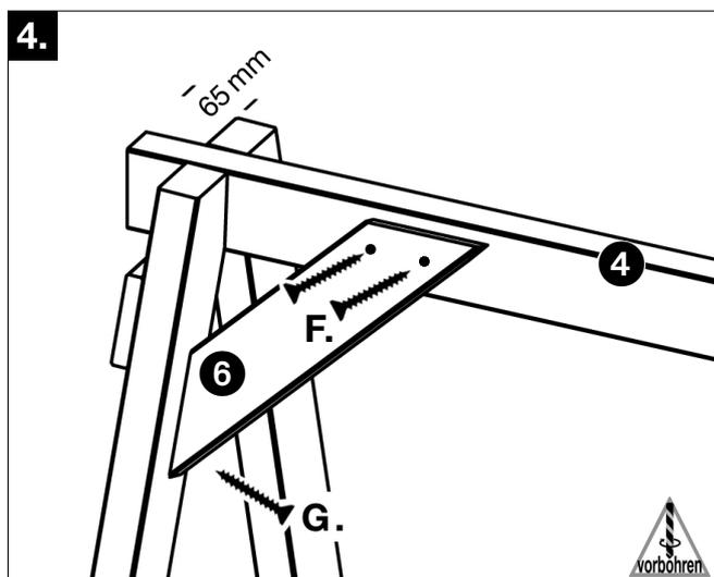
Obere Diagonalleiste positionieren und fest verschrauben.
