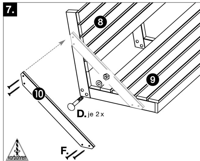
Die Eckverbindung der Bankteile 8 und 9 zusammenstecken und fest verschrauben. Ggf. die Löcher nachbohren. Diagonalleiste positionieren und fest verschrauben.
