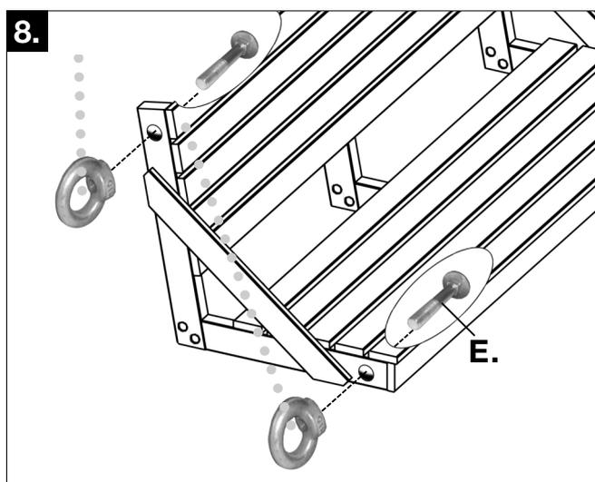
Schrauben von innen durchstecken und die Ringmuttern fest aufschrauben.
