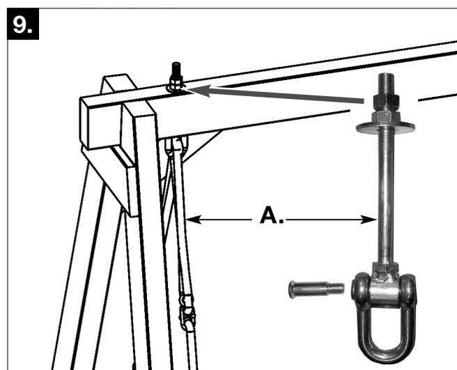
Schaukelhaken durch den Firstbalken stecken und die Muttern fest gegeneinander schrauben. Innensechskant lösen, Bänder einhängen und Innensechskant wieder eindrehen.
