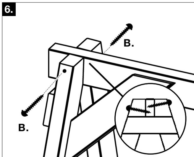
Vorböhrern: Firstbalken  $\varnothing$  4 mm, Wange 8,5 mm. System-schraube versetzt gegeneinander eindrehen (siehe Detailbild)! Den Schraubenaufsatz (BIT) bitte gut aufbewahren.
