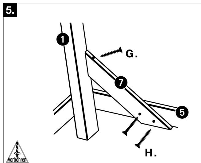
Untere Diagonalleiste positionieren und fest verschrauben.
