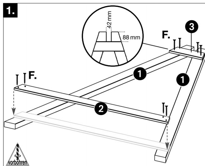
TIPP: Liegend montieren. Auf genaues Fugenmaß achten. Firstbalken muß später stramm in die Öffnung passen.
