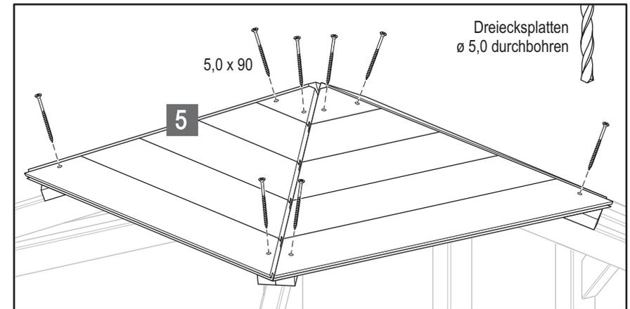
**5** Richten Sie die Dreiecksplatten auf den Sparren aus und fixieren Sie diese vorerst mit 1-2 Schrauben in der Dachspitze. Das endgültige Verschrauben der Elemente erfolgt nach dem Auflegen und Ausrichten der Trapezplatten.
