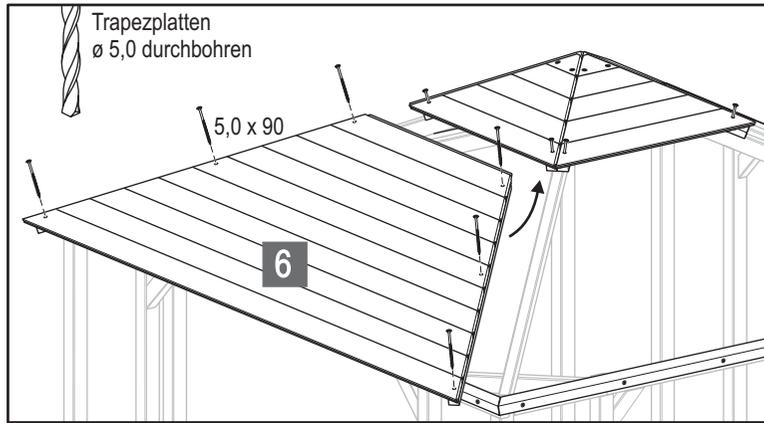
**6** Die vier Trapezplatten auflegen und mit den Federn in die Profilbrettnuten der Dreiecksplatten schieben. Die untere Schraubenreihe lose in die Bohrlöcher stecken, damit sich die Gesimsbretter noch darunter schieben lassen.
