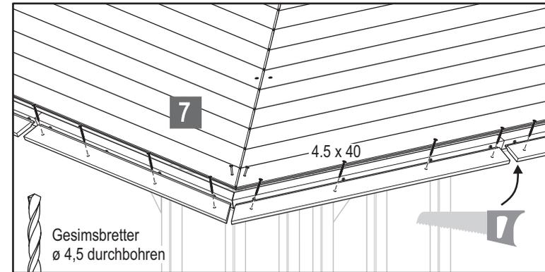
**7** Gleiche Montagereihenfolge wie bei den Falzleisten. Gesimsbretter erst an zwei gegenüberliegenden Ecken in die Profilbrettnut der Trapeze schieben und verschrauben. Danach die restlichen Gesimsbretter einpassen, durchbohren, einschieben und anschrauben. Zum Schluss die losen Schrauben von Trapez- und Dreiecksplatten anziehen.
