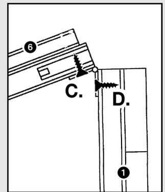
\***ACHTUNG:** Beim Einbau der Fenster muss zum optimalen Wasserablauf die rückseitig gefalzte Seite nach unten weisen.
