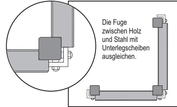
Die Fuge zwischen Holz und Stahl mit Unterlegscheiben ausgleichen.
