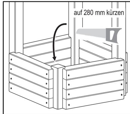
Tipp: Richtige Stabilität erhalten Sie, wenn Sie die einzelnen Kastenmodule untereinander mit je zwei Schrauben 6 x 120 zusätzlich verbinden.
