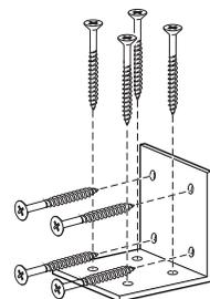
Standardwinkel verzinkt 60/60/60 und entsprechende Schrauben und Dübel.
