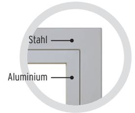
Der Torrahmen besteht aus einem Stahlrahmen feuerverzinkt, gepulvert und einem Aluminiumrahmen eloxiert, gepulvert. Durch die Materialkombination kann es zu leichten Farbabweichungen kommen.
