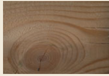
Nœuds sur une surface à caractère
