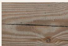
Fissures de contrainte provoquées par le séchage du bois
