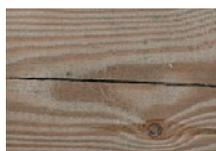
Spannungsrisse durch die Holzrocknung
