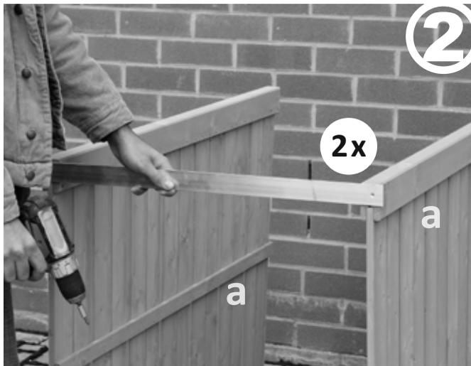
Beide Seitenteile unten mit der mitgelieferten Aluleiste verschrauben. Tipp: Zur leichteren Montage legen Sie die Box auf die Rückseite und verschrauben die Aluleiste jeweils mit 4,0 x 25 mm Schrauben.
