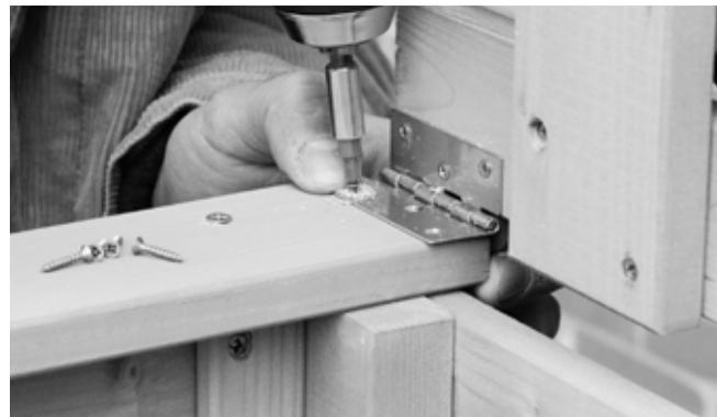
Die restlichen 2 Scharniere an der Hinterseite (ohne Querleiste) außen und bündig am Klappdeckel mit 3,0 x 16 mm Schrauben befestigen. Den Klappdeckel hinten bündig auf den seitlichen Abdeckleisten ansetzen und mit 3,0 x 30 mm Schrauben verschrauben.
