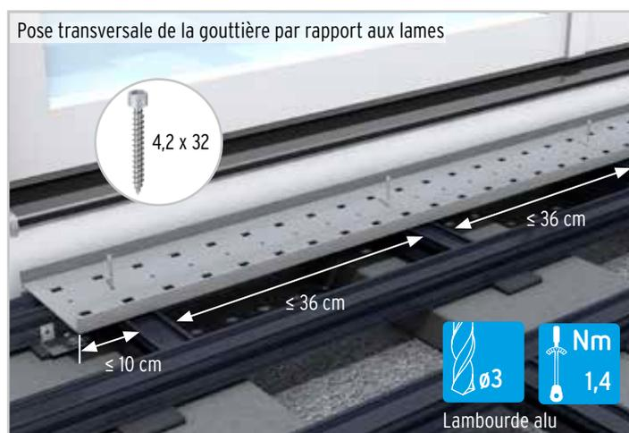
La grille de drainage DREAMDECK peut être montée transversalement ou parallèlement aux lames, ainsi qu'avec ou sans la gouttière de drainage DREAMDECK.
