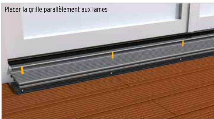
Monter la grille de drainage sans la gouttière
