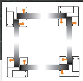
Vue schématique des poteaux d'angle / lames / vis de fixation
