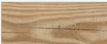
Trocknungsrisse (nach DIN zulässig)
