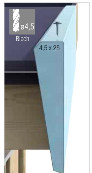
Wand- und Giebelabschluss - Grundprinzip: Abtropfbleche, Wand oben - Giebelblenden
