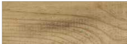
Stockflecken mit chlorhalt. Reiniger entfernen
