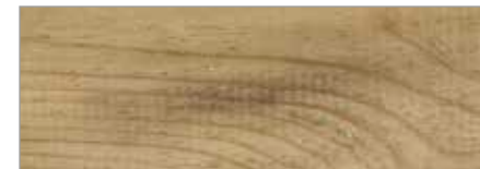
Stockflecken mit chlorhalt. Reiniger entfernen
