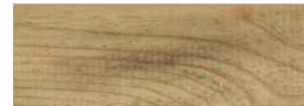
Stockflecken mit chlorhalt. Reiniger entfernen
