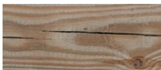
Fissures de contrainte provoquées par le séchage du bois
