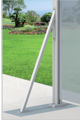
Acier, vis à tête ronde et écrou inclus pour le montage sur poteaux métalliques TraumGarten (7 x 7 cm) et pour tous les poteaux de bois courants (9 x 9 cm). Le matériel de fixation au sol doit être acheté séparément. La fixation avec la vis à tête ronde doit être réalisée depuis la face avant. Percez des trous de 8,5 mm de Ø au préalable dans les poteaux. Le collet carré de la vis à tête ronde s'intègre parfaitement dans l'encoche de l'ancrage contre le vent.
