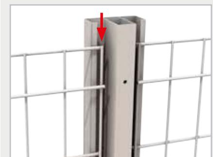
Die Gitterelemente sind innerhalb des Rasters kürzbar. Ein senkrechter Steg muss zur Stabilisierung im Pfosten verbleiben. Die Schnittflächen mit den passenden Sprühlacken (Artikel E1116 oder E1117) versiegeln.
