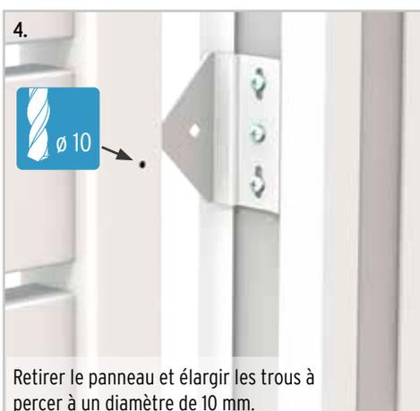
Retirer le panneau et élargir les trous à percer à un diamètre de 10 mm.
