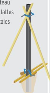
**d)** Placez tous les poteaux dans les trous préparés dans le sol et accrochez-y les panneaux. Veuillez régler les vis d'ajustage de façon à ce que les panneaux s'accrochent facilement.
