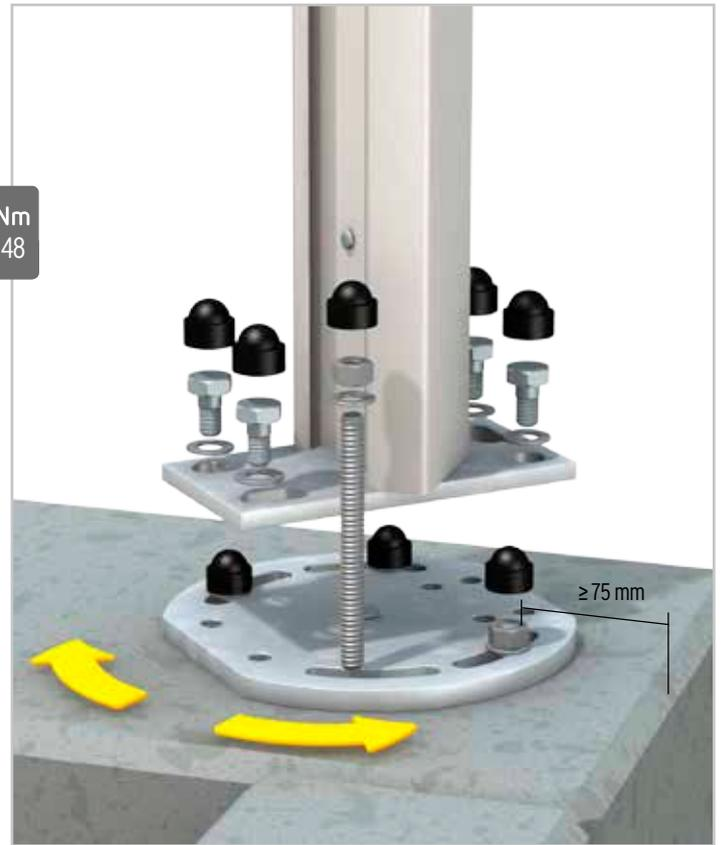
Mit den Montageadaptern können Sie eine SYSTEM Sichtschutzanlage auf eine Betonmauer setzen. Die Adapter passen zum aufschraubbaren SYSTEM Pfostenträger. Mitgeliefert werden die Schrauben, Unterlegscheiben und Abdeckkappen für die Verbindung dieser beiden Elemente. Mindestabstand der Bohrungen zur Mauerkante 75 mm in jede Richtung.
