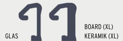
Die Gummidichtungen aufstecken und punktuell an drei Stellen mit doppelseitigem Klebeband fixieren. Die passenden Dichtungen sind den Zaunelementen beigelegt. Bei Eckpfosten muss zusätzlich die Adapterleiste eingesetzt werden.
