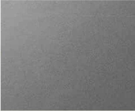
*Auslieferungszustand: walzblanke Oberfläche mit schützender Ölschicht.*
