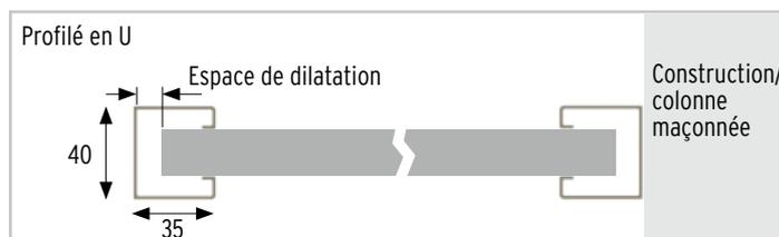
L'espace nécessaire à la dilatation du matériau se crée automatiquement lorsque les panneaux sont alignés exactement au milieu, s'ils sont montés conformément à l'entraxe et à la distance entre les poteaux indiqués.
