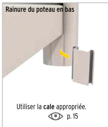
Assembler avec précaution les lamelles et leurs fixations pour les poteaux (5 lamelles et 2 fixations). Lors de cette opération, veiller à orienter le **joint soudé des lamelles vers le bas**.
