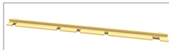
Mit der Montageschablone JUMBO wird das Zwischenmaß der Pfosten für 178,5 cm breite Zaunfelder sowie die Position der Elementhalter für alle Zaunfelder der Serie bestimmt.
