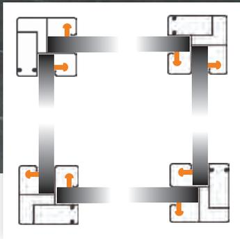
Schematische Aufsicht auf die Eck-Pfosten mit den Profilen und Fixierungsschrauben
