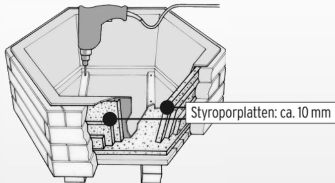
**Wichtig:** Für optimalen Sitz unterfüllern Sie bitte den Einsatz seitlich und von unten mit ein wenig Styropor (siehe Skizze), damit sich dieser durch das Erd-/Wassergewicht nicht verformt.
